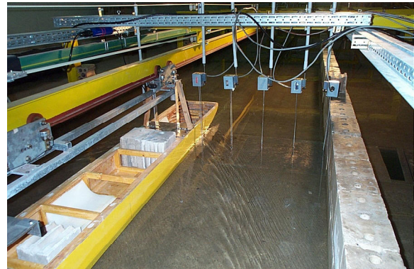
Abb. 3-1: Typische Modelluntersuchung zu den Strömungs- und Wellenfeldern um sich bewegende Binnenschiffe in der Versuchsanlage Schiffsrinne des FRANZIUS-INSTITUTS FÜR WASSERBAU UND KÜSTENINGENIEURWESEN DER UNIVERSITÄT HANNOVER
