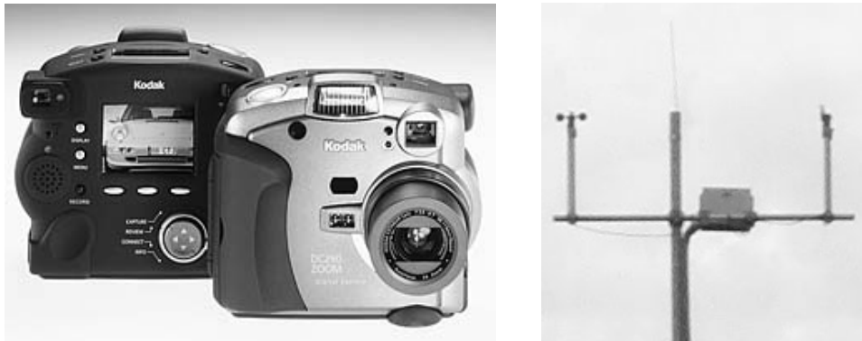
Abb. 3-6: Eingesetzte Digitalkamera mit Wetterstation im Bereich des Messquerschnitts der Sanierungsvariante 3
