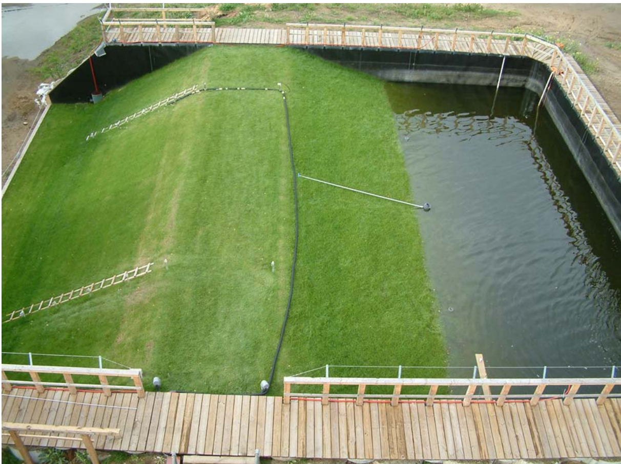
Abbildung 3-19: Fertiger Labordeich (Füllstand ca. 1,5 m)
