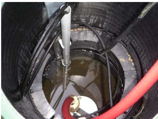
Abbildung 4-3: Foto der Sickerwasser-Druckmessdose (links) und verwendete Wasseruhr (rechts)
