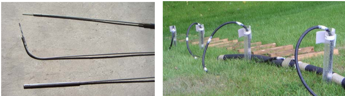
Abb. 4-1: Messfühler PT100 (links) und Einbau in der luftseitigen Böschung des Labordeichs (rechts)
