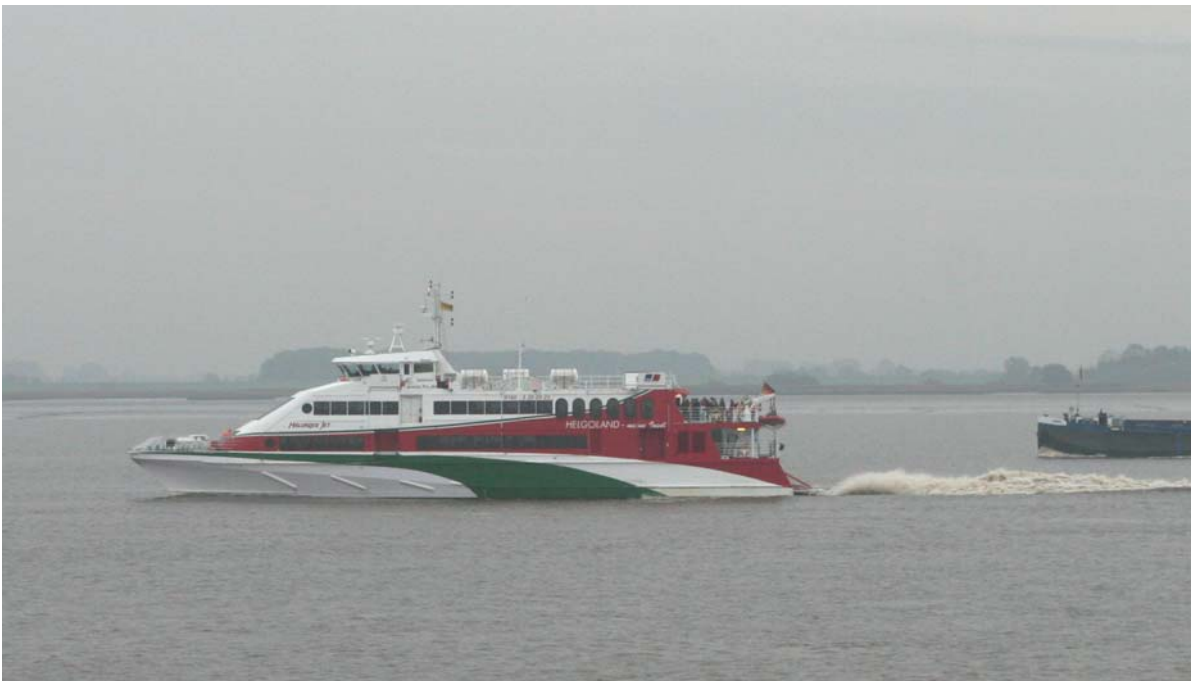
Abbildung 5-2: Typisches Wellenbild einer Schnellfähre (Schnellfähre 1: Fahrtgeschwindigkeit über Grund: 18,5 kn, Fahrtrichtung: stromab, Abmessungen: L_{\text{Schiff}} * b * T = 50 * 12 * 2,6 )
