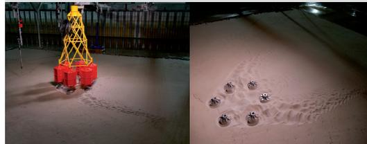
Abb. 2: TexBase Variante Suction Buckets; nur Strömung  $v = 0,27$  m/s;  $t = 90$  min
