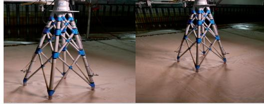
Abb. 1: HyConCast nur Strömung  $v = 0,27$  m/s;  $t = 15$  min (rechts);  $t = 90$  min (links)
