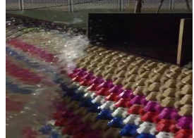
Abb. 1: Wellenauflauf unter schrägem Wellenangriff am Modell im Wellenbecken
